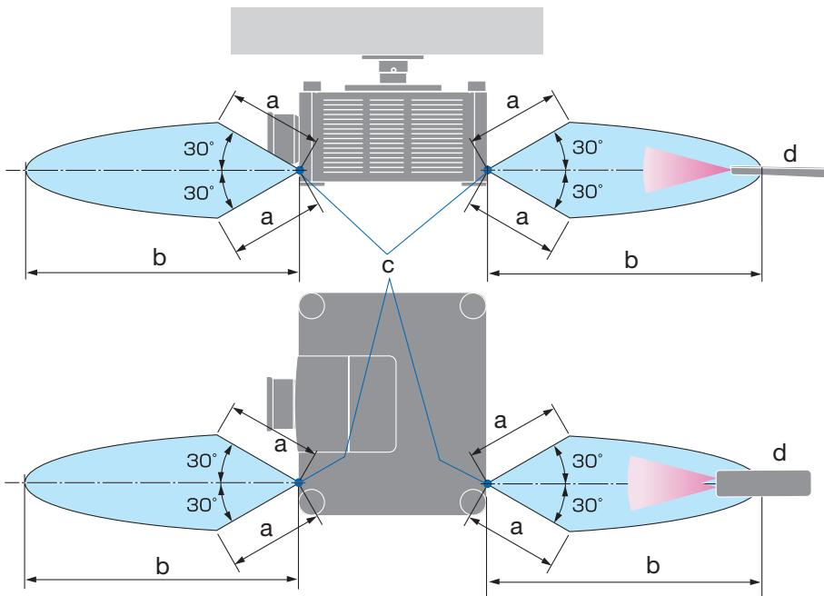
a: 7m/276" / b: 20m/787" / c: 프로젝터 본체의 원격 센서 / d: 리모컨
