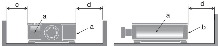
a : Entrée d'air / b : Évent d'échappement / c : 30 cm/12" ou plus / d : 50 cm/20" ou plus
