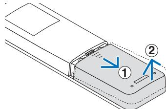
2. Installez des piles alcalines AAA. Veillez à ce que la polarité (+/-) des piles soit correctement alignée.
