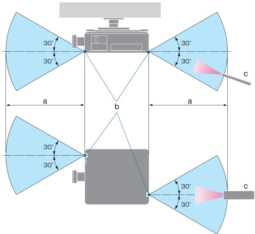
a : 7 m/276"/b : Capteur de télécommande sur le boîtier du projecteur / c : Télécommande
