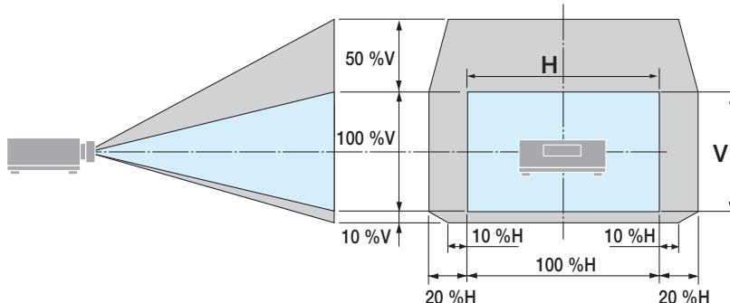
符号说明：V代表垂直（投射影像的高度），H代表水平（投射影像的宽度）。
