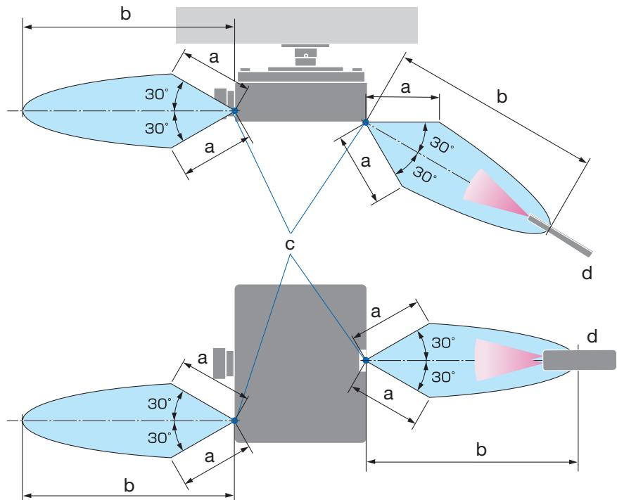
a: 7米 / b: 20米 / c: 投影机机箱上的遥控传感器 / d: 遥控器
