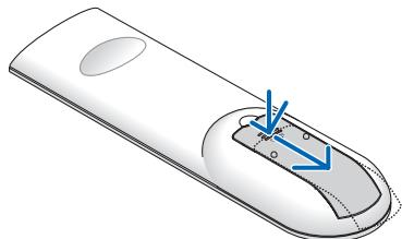
2. 새 배터리(AAA)를 설치합니다. 배터리의 극성(+/−) 방향이 올바른지 확인하십시오.
