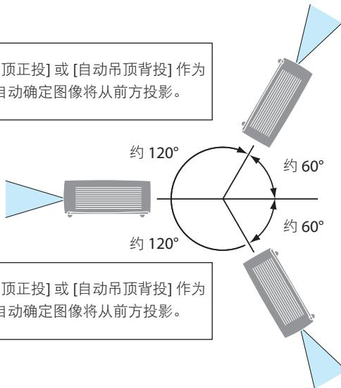
如果选择 [自动吊顶正投] 或 [自动吊顶背投] 作为方位，投影机将自动确定图像将从前方投影。
