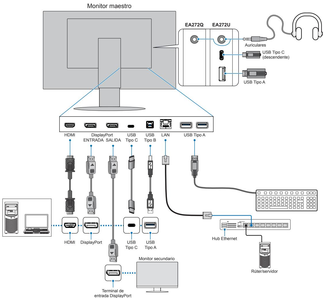
Para asegurar el cumplimiento de las normativas EMC, use cables apantallados para conectar el equipo a los siguientes terminales: puerto USB, puerto USB Tipo C, terminal de entrada HDMI y terminal de entrada DisplayPort.
