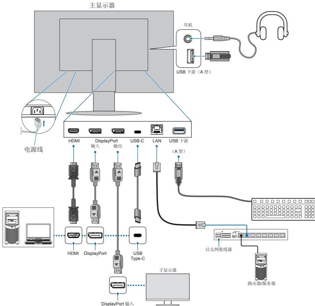
为保持符合EMC法规，请使用屏蔽线连接以下端子：DisplayPort IN、HDMI IN、USB下游端口（A型）和USB-C®端口。
