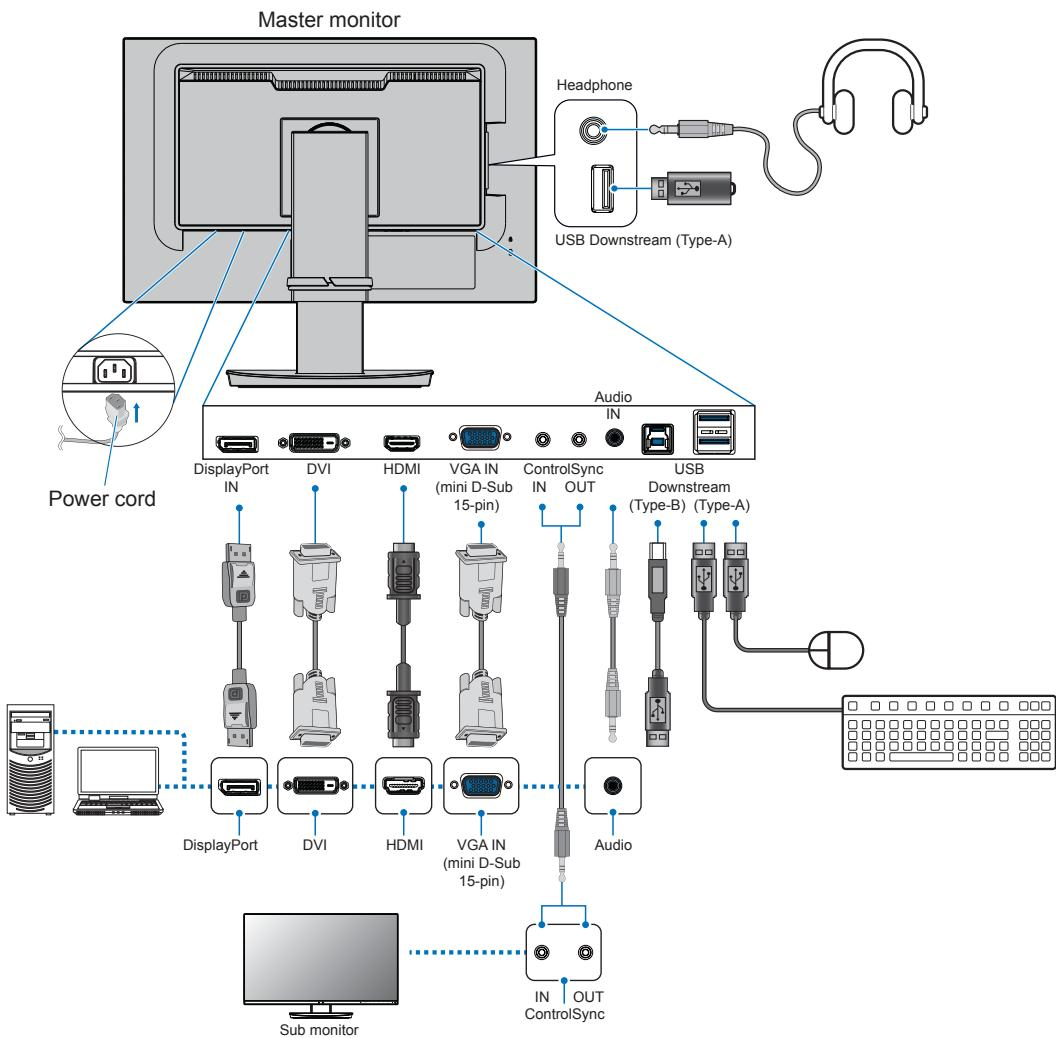
Per garantire la conformità alle normative EMC, utilizzare cavi schermati per il collegamento ai seguenti terminali: HDMI IN, DisplayPort IN, porta USB a valle (Tipo-A), porta USB a monte (Tipo-B) e Audio IN. Utilizzare cavi di segnale con nucleo in ferrite per il collegamento ai seguenti terminali: VGA IN e DVI IN.
